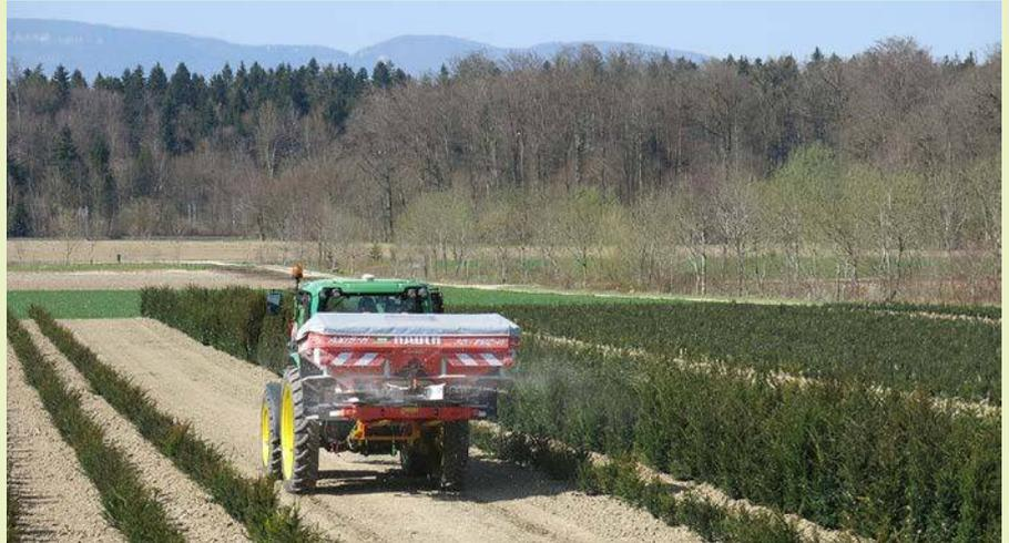
Genauigkeit bei der Ausbringung: GPS-Ausrüstung und High-End-Anbaugerät ermöglichen eine Düngemittelleinsparung von bis zu 20%.
